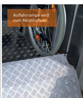
Auffahrrampe wird zum Abrollschutz
